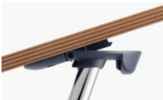
Klappmechanismus mit Schnappverschluss. Zum Entriegeln den Griff nach vorn ziehen und die Tischplatte aufklappen.
